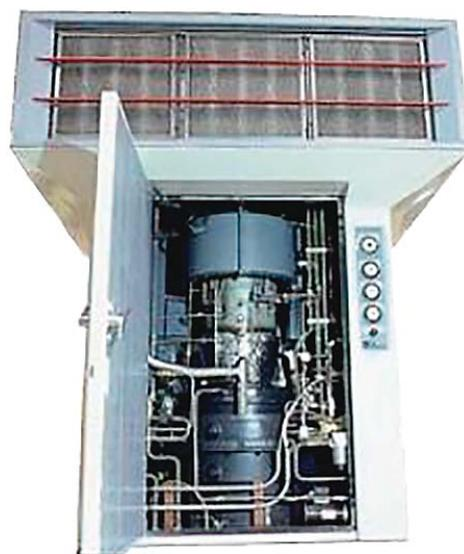
図-1 ガスタービン (左:1軸式ガスタービン、右:立軸ガスタービン)
