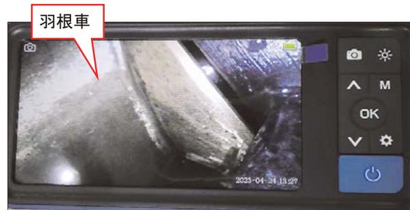
写-3 工業用内視鏡でのポンプ内部点検画像
